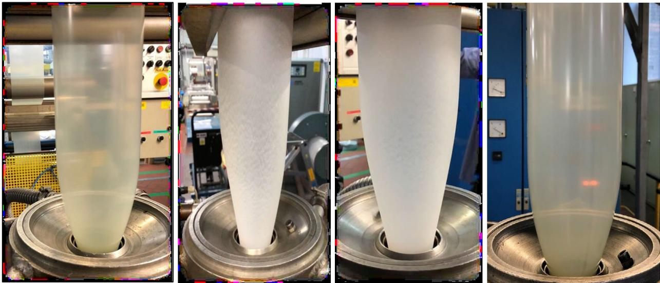
Abb. 29a–d: Optik der Monofolienblase (Schmelztemperatur):
