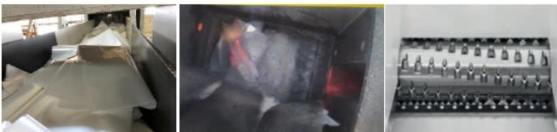
Abb. 25: S Gran 95 Impressionen (von links: Materialzufuhr, Schneidwerk, Schnecke)
